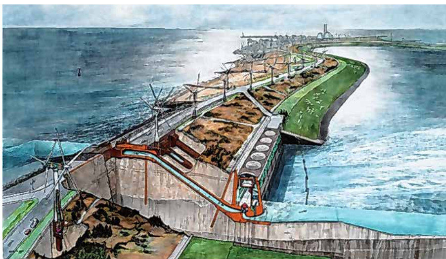
Dijkdoorsnede van het principe van een valmeer. (Bron: gebr. Das)
